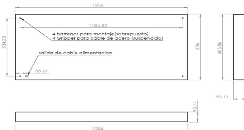
2. Para suspender colocar el cable de acero en los gripper ya incluidos ajustar de uno en uno para equilibrar el luminario.
