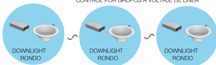
CONTROL POR GRUPOS A VOLTAJE DE LÍNEA
