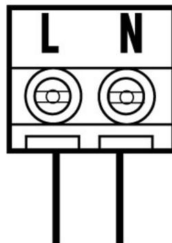
\*Para realizar las conexiones, destornillar ligeramente los tornillos y colocar el cable. Ajustar nuevamente los tornillos.
