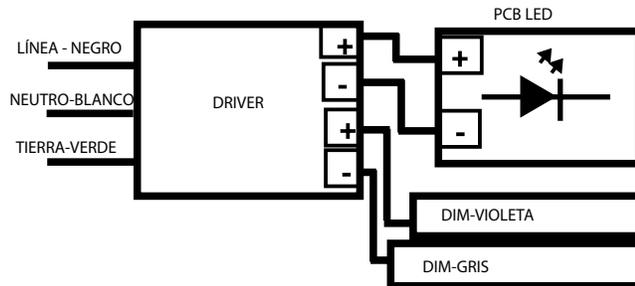
\*Si no utiliza los cables de atenuación aislar ambos extremos por separado conforme a la normativa.
