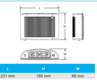
La serie MURO LED integra fotocelda y kit de emergencia con 90 min de respaldo. Con opción a un sensor de detección de movimiento (Sensor PIR).
