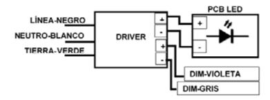
\*Si no utiliza los cables de atenuación aislar ambos cables, revisar la etiqueta del cable.
