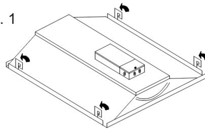
2. Sujete el luminario de los ganchos con el cable (sistema de seguridad, realice las conexiones aléctricas, acceda a los conductores retirando el tornillo superior del Housing (Fig. 2))
