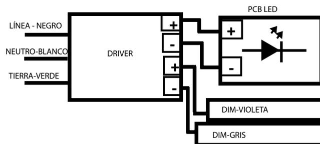
\*Si no utiliza cables de atenuación, aislar ambos extremos por separado conforme a la normativa.
