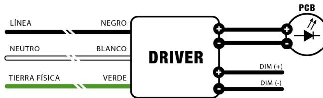
\*Si no utiliza los cables de atenuación aislar ambos extremos por separado conforme a la normativa, revisar la etiqueta del cable.
